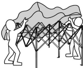
Enlevez maintenant le toit de la charpente et repliez soigneusement la toile
