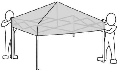
Trek nu het hele frame op dezelfde manier als hierboven vermeld verder uit tot deze niet verder kan. Er mag best wat druk op gezet worden. De pallen mogen nog een 5cm van het gat verwijderd zijn. Druk nu op alle hoeken de pallen de hoeken aan tot u een klik hoort. Hier kan wat kracht voor nodig zijn. Let wel op dat alle hoeken van het dak doek goed op het frame zitten.
