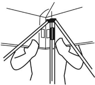
Repliez la charpente jusqu'au milieu, détachez les velcro, ainsi que la bande d'attachement des pointes
